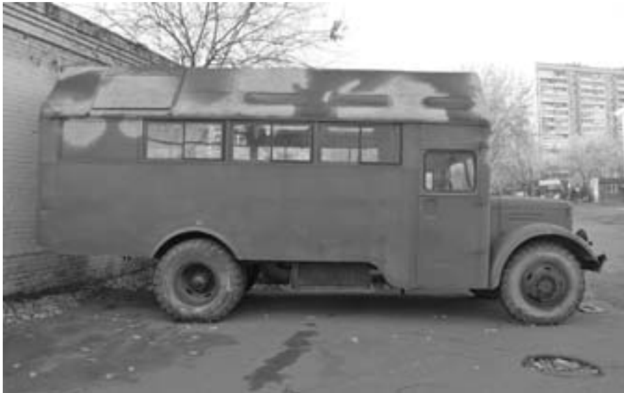
Компрессорное отделение (машина) азото-добывающей станции АДС-50 на шасси МАЗ-200П. Музей ретро-автомобилей на Рогожском валу, Москва.
